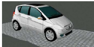
OpenCRGによる不整路面定義上 MF-Swift搭載車両走行モデル
