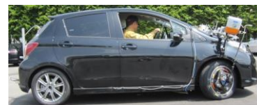
極低速走行ステップステア試験の様子
